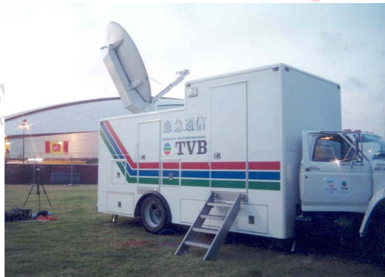
正在为某军事演习提供语音通信的车载 1000 线程控交换车
