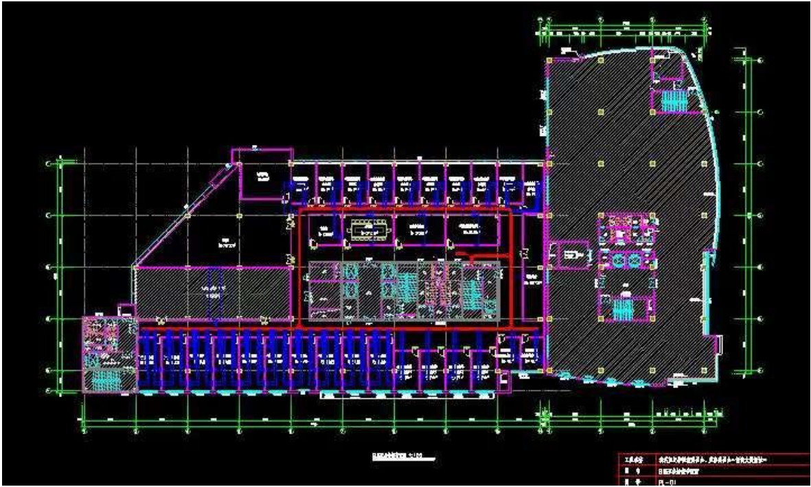
图 22 综合布线五层点位分布图
