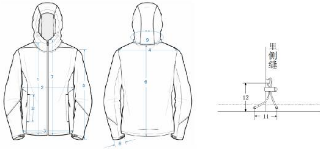
图 1-3-2 防晒服成品规格尺寸测量图
