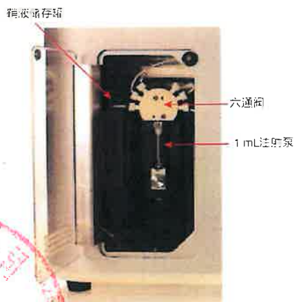
图4. 正向位移注射泵。注射泵更易于拆卸清洗或更换。
