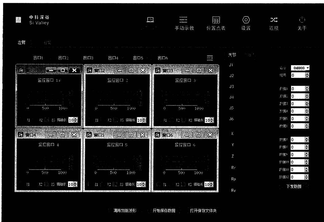
图 9 双臂的 36 通道数据采集、控制参数在线修改界面
