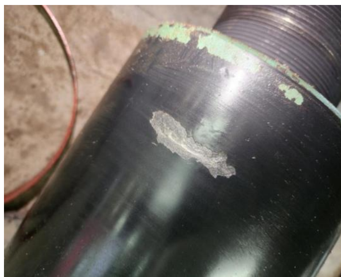
图 4 一级活塞杆局部镀层脱落
