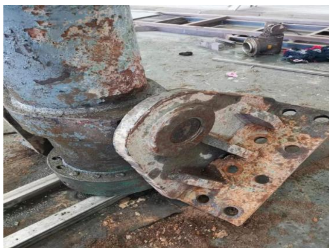
图 5 液压缸中间铰轴锈死
