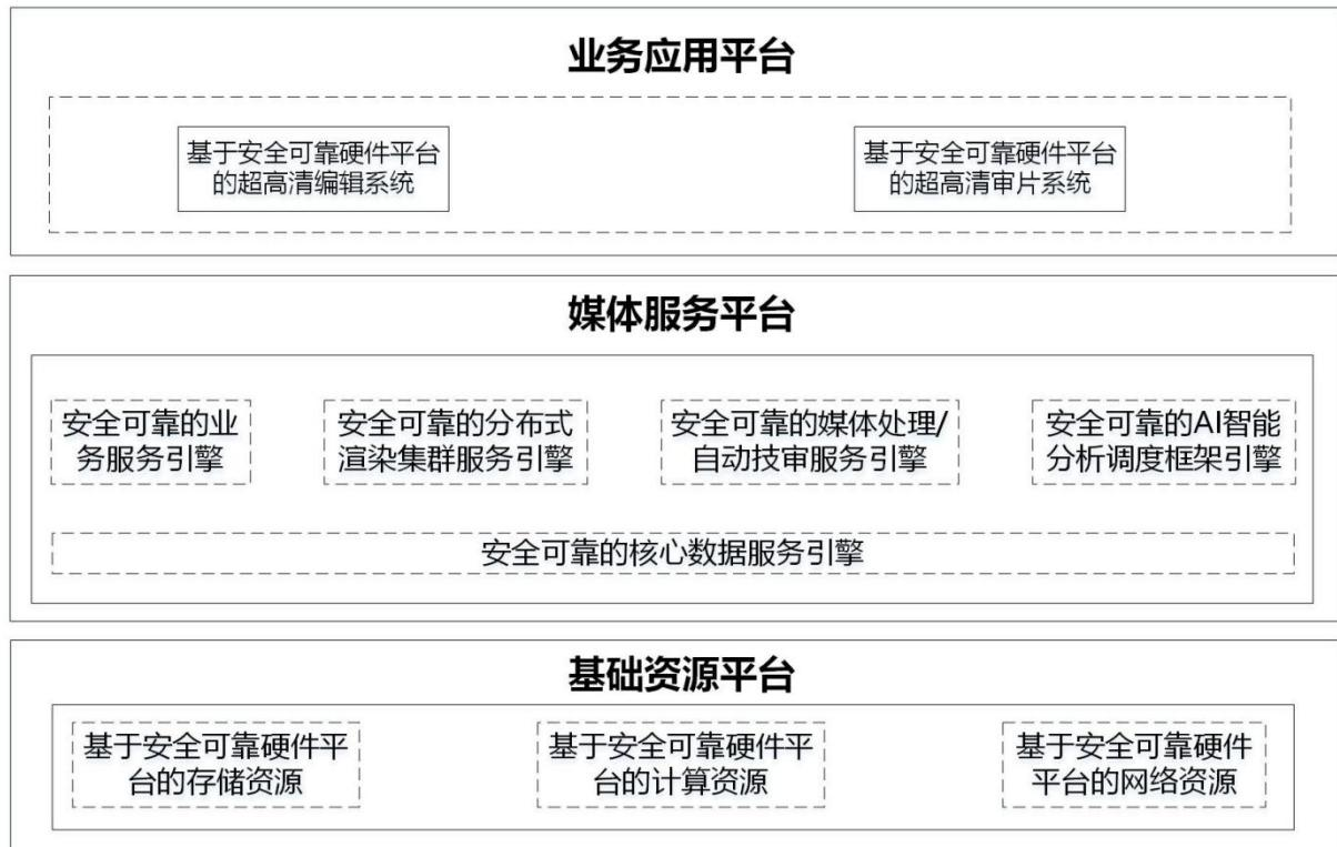
整个平台建设要求基于云原生架构，采用容器化的部署方式，构建基于符合安全可靠测评要求的硬件平台的 4K 超高清节目生产服务体系，如上图所示，总体架构自下而上的三个层次分别为基础资源层、媒体服务层和业务应用层。
