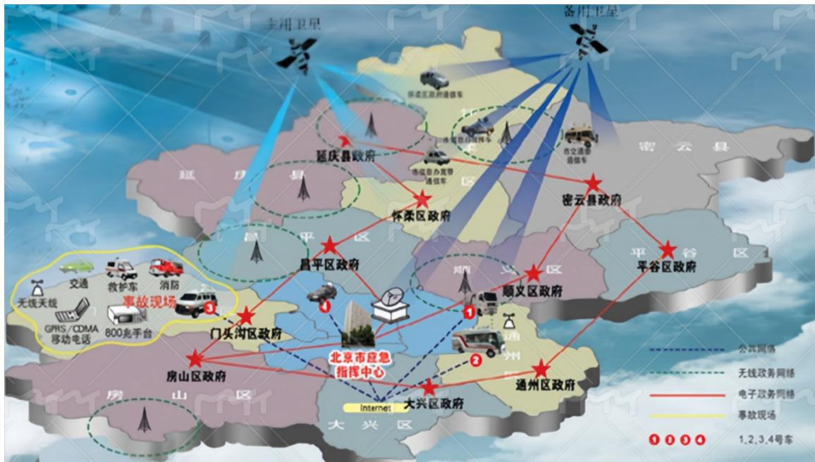
北京市应急卫星通信系统主要包括：2个卫星主站（黑庄户主站和密云主站备份站）、3个卫星小站（房山，延庆，密云）及其相关通信设备、市通信保障应急指挥部1辆应急车、卫星通信电话2部。
