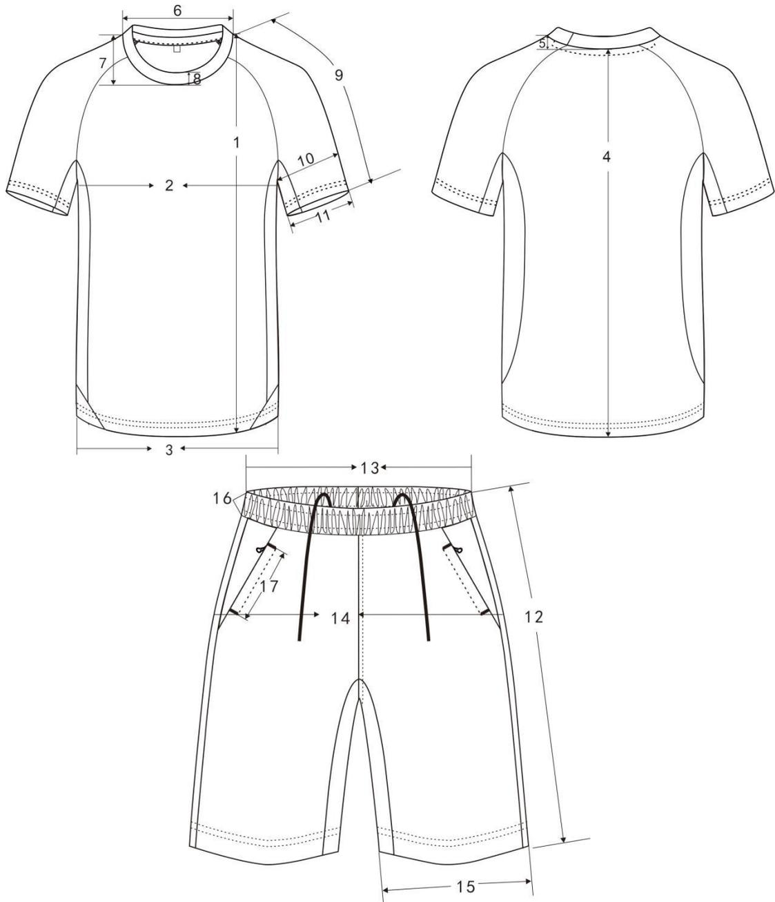
图 2 男速干面料短袖 T 恤测量图
