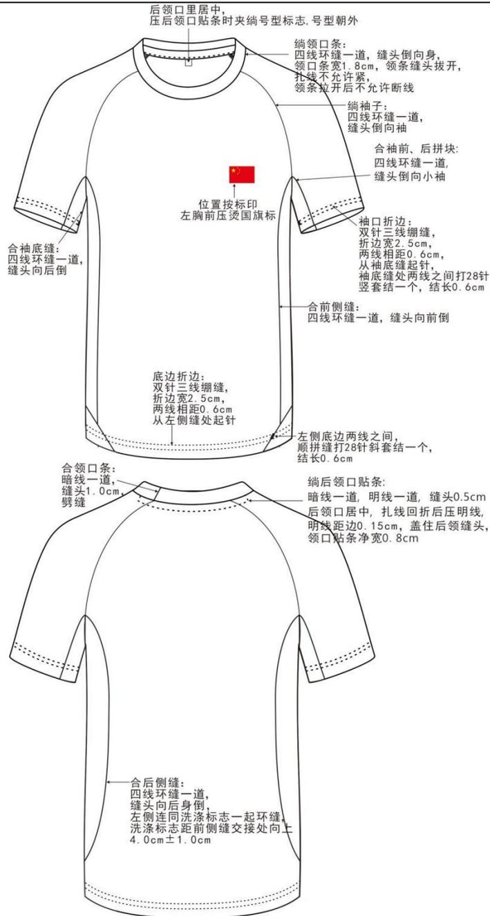
图 4 速干面料短袖 T 恤衫工艺要求
