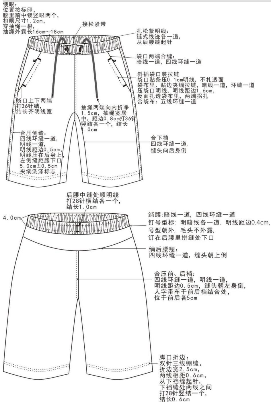
图 5 速干面料短裤缝制工艺要求
