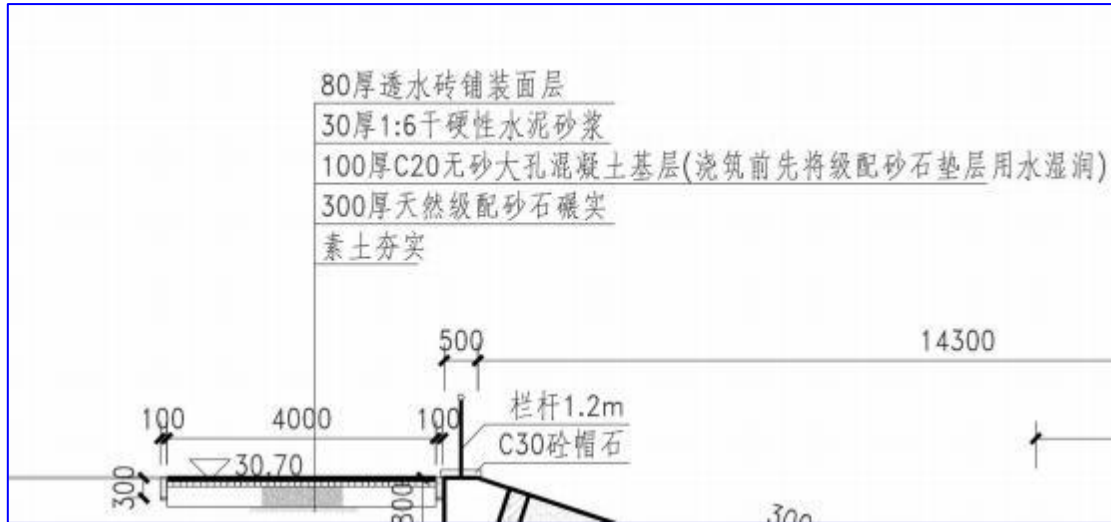
透水步道修复断面图
