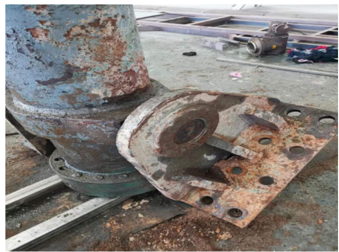
图 5 液压缸中间铰轴锈死
