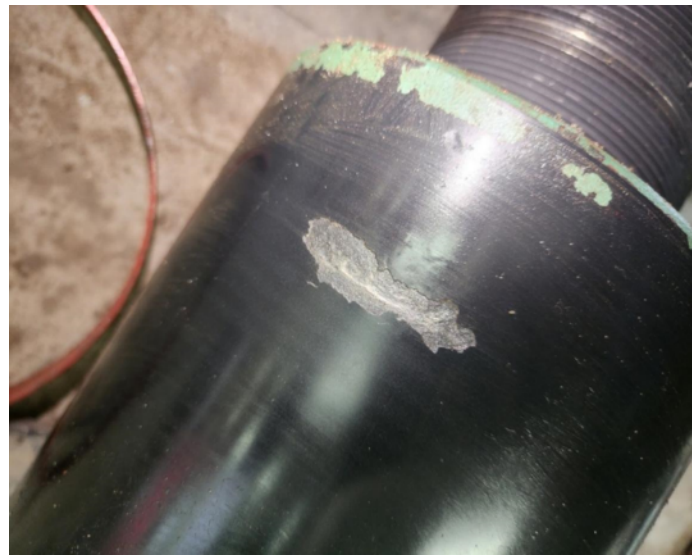
图 4 一级活塞杆局部镀层脱落
