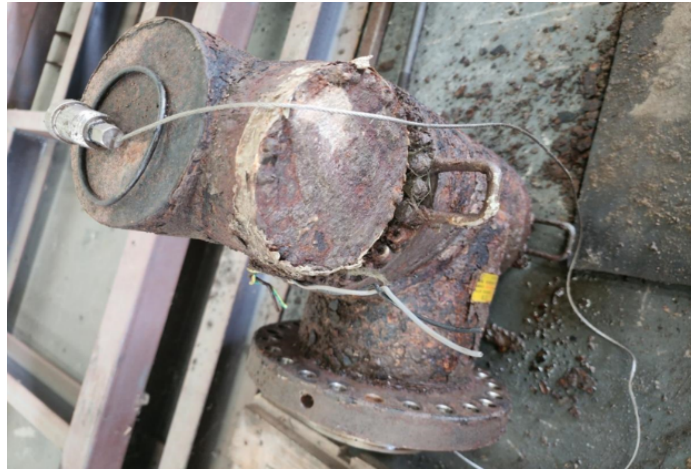
图 6 位移传感器外观锈蚀严重，传感器失效
