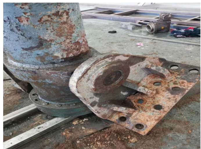
图 5 液压缸中间铰轴锈死
