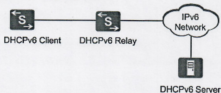
图 1.3 DHCPv6 地址分配方案架构
